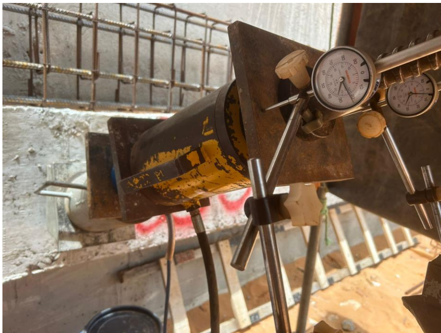
Figura 4. Ensaio de fluência em tirante.
